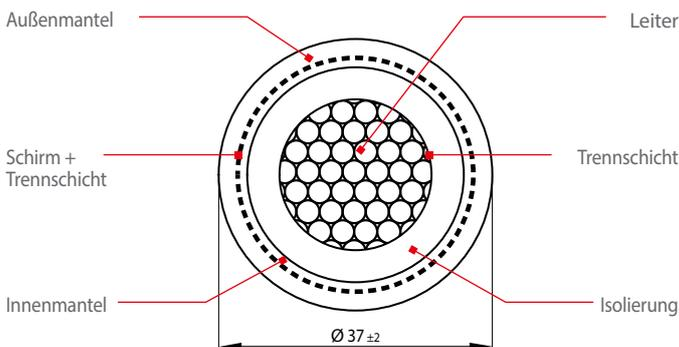
Das 1-polige Anschluss- oder Verbindungskabel ist als Meterware direkt bestellbar und erfüllt die Vorschriften der EN 45545.
