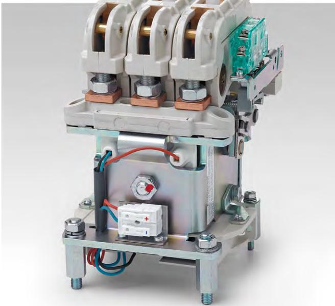
Schaltbau hat seine seit Jahrzehnten bewährten Nockenschütze weiterentwickelt mit dem Ziel, die Schaltgeräte im Hinblick auf Halteleistung und Wärmeabgabe energieeffizienter auszulegen und damit deren Eigenstromverbrauch zu reduzieren. Die Nockenschütze haben jetzt genauso wie die CT und CA Leistungsschütze eine Zweiwicklungsspule mit elektronischer Spulenumschaltung.
